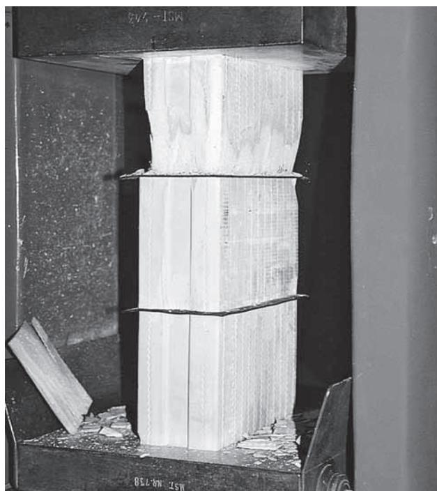
Die Steinquerzugfestigkeit wird aus Druckversuchen an fünf Prüfkörpern ermittelt, die aus je drei geschliffenen Backsteinen mit zwei dazwischenliegenden Gummiplatten bestehen. Die Gummiplatten simulieren dabei die Wirkung des Mauer Mörtels im Mauerwerk. Die Querzugfestigkeit des Backsteins entspricht etwa der Mauerwerksdruckfestigkeit.
