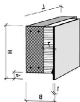
**HINTERSTÜRZE ECOMUR TYP 11, DÄMMUNG  $\lambda_D$  0.031 W/MK**
