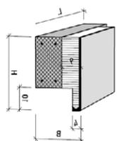
**HINTERSTÜRZE ECOMUR TYP 14, DÄMMUNG  $\lambda_D$  0.036 W/MK**
