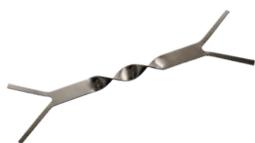
DIN-Werkstoff-Nr. 1.4435 (V4A-Stahl)
